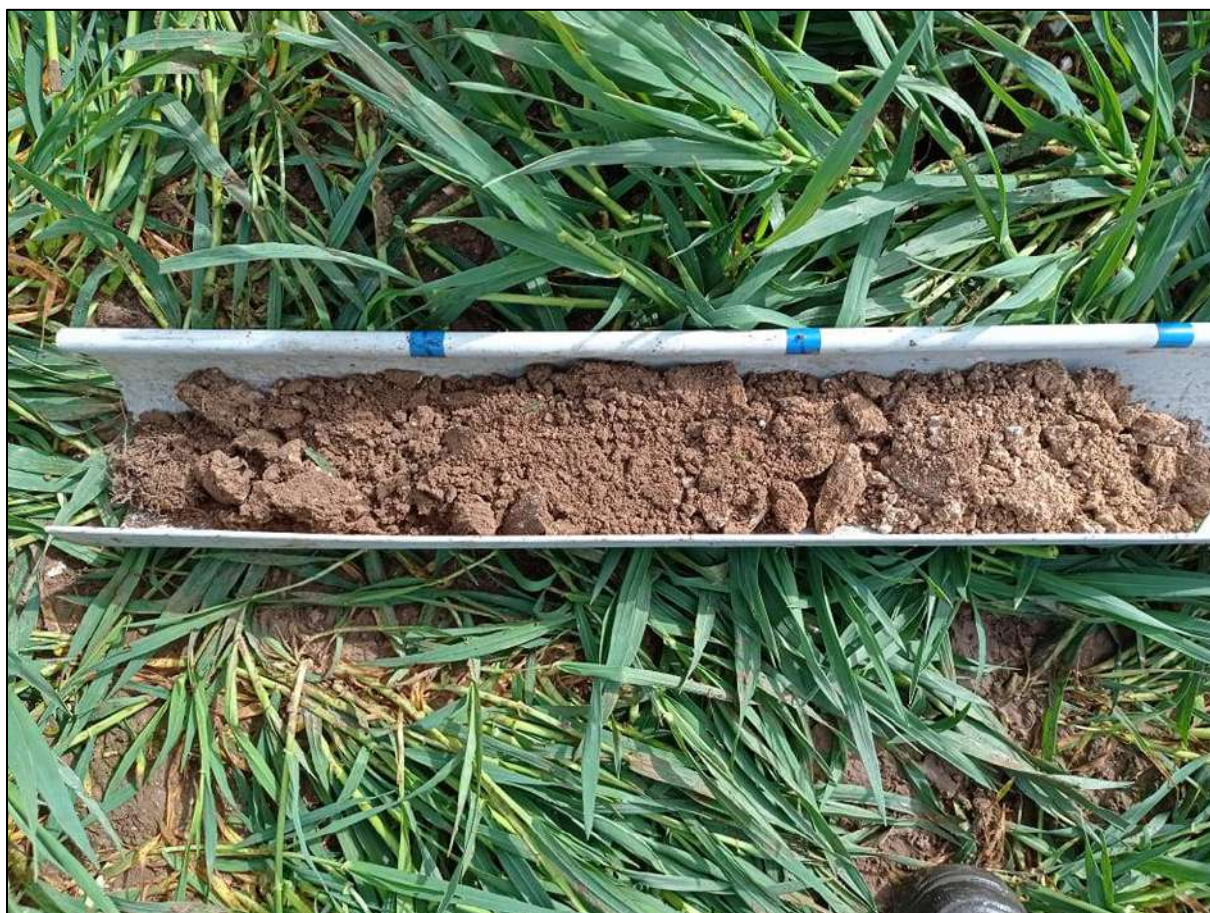
Figure 14 : Profil typique des sondages pédologiques (ici sondage 2)
