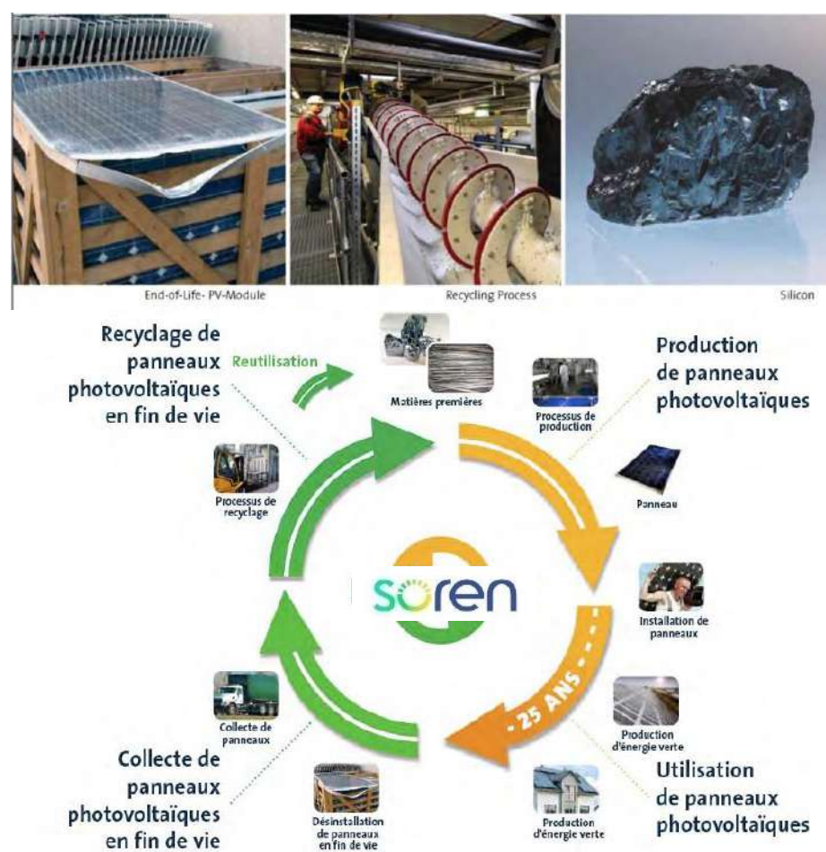
Figure 35 : Cycle de recyclage d'un panneau photovoltaïque
