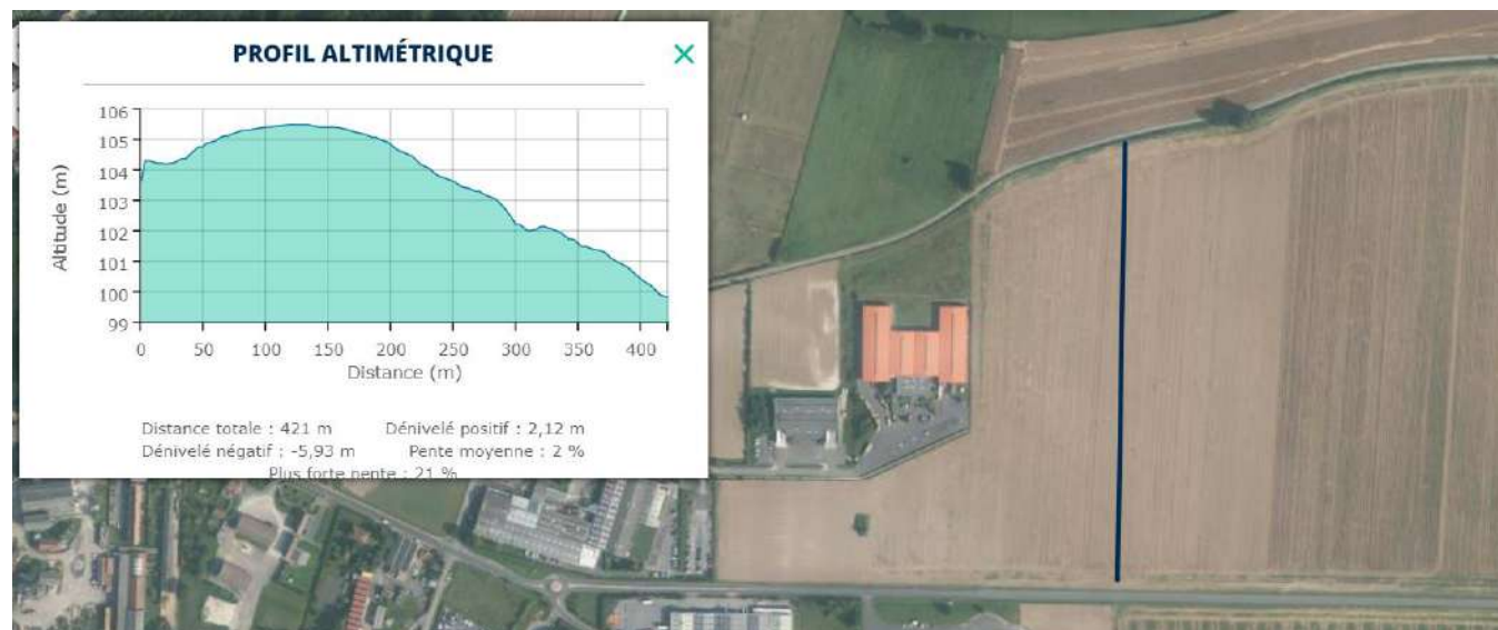
Figure 12 : Profil altimétrique (axe vertical) du site d'implantation
